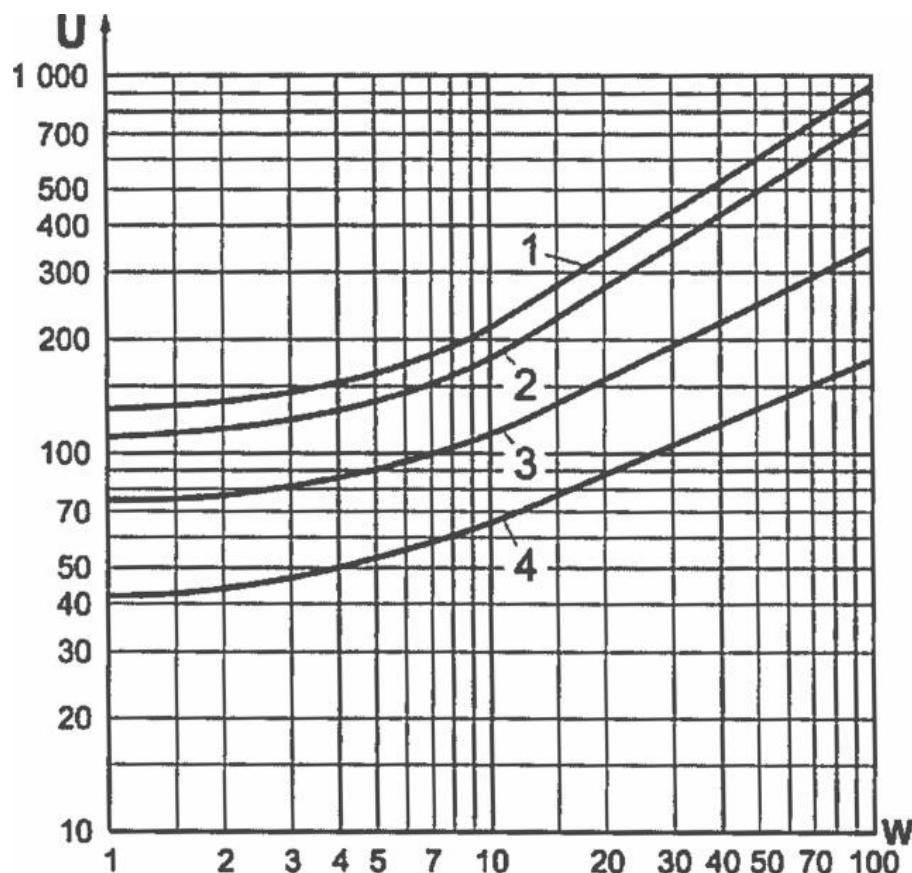
Рисунок 1. Максимальное напряжение на рентгеновской трубке для источников до 1000 кВ в зависимости от радиационной толщины и материала:
